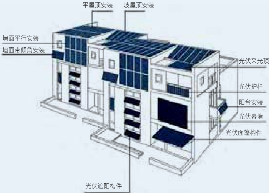
图2 光伏组件与建筑的结合
